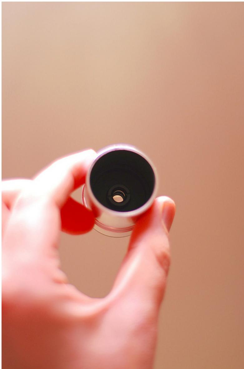
Посадочный диаметр всех окуляров — 1.25 дюйма, на внутренней стороне каждого есть резьба для установки светофильтров.
