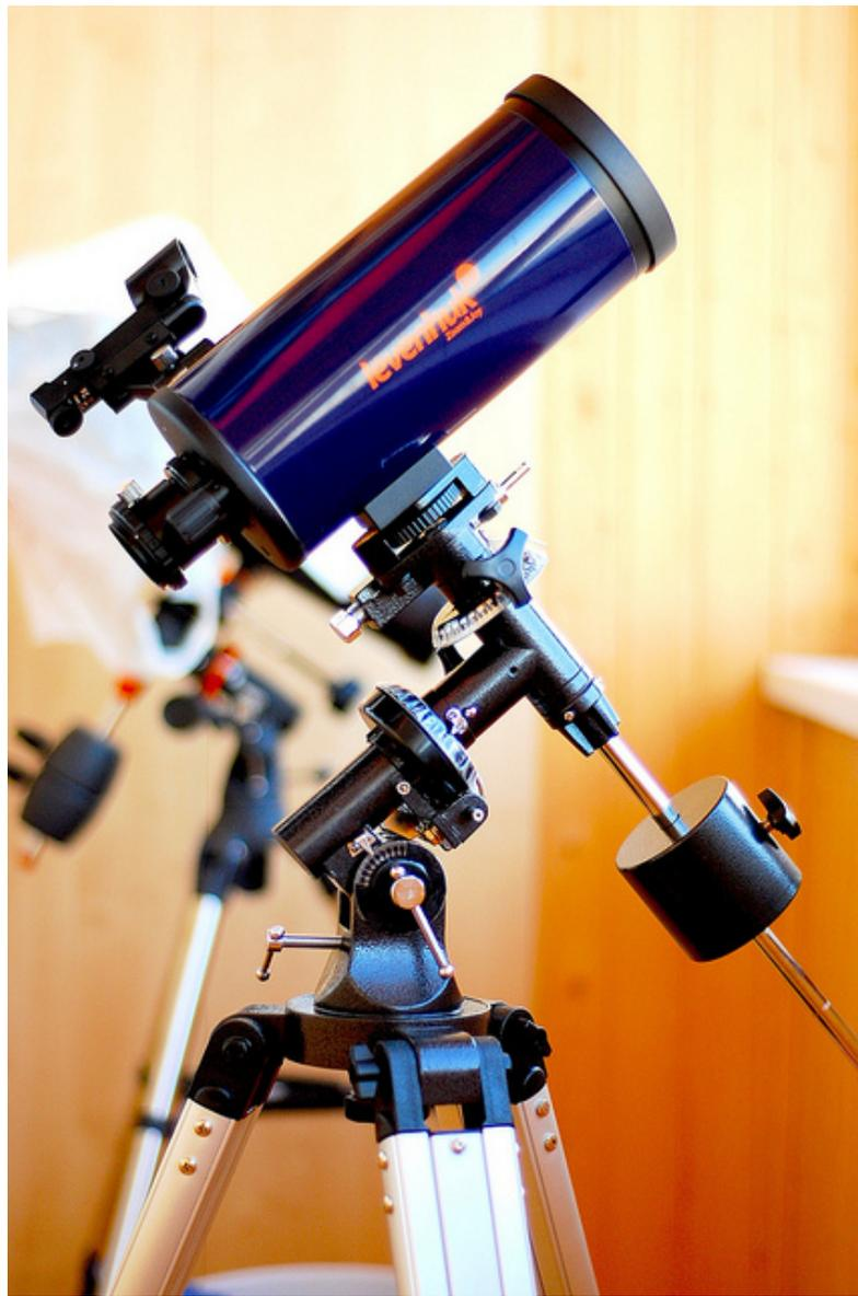
Итак, перед нами представитель класса зеркально-линзовых телескопов. Levenhuk Strike 1000 PRO построен по схеме Максутова – Кассегрена, что дает нам в итоге большие увеличения при крохотном размере трубы телескопа. О [достоинствах и недостатках](#) схемы можно прочесть в Википедии, поэтому я не буду на этом подробно останавливаться.
