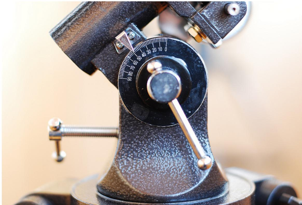
Стопорным винтом (слева на фотографии) фиксируем требуемое значение широты и зажимаем полярную ось вторым винтом (по центру на фотографии). Винт держит заданную широту железобетонно. Ни малейшего сдвига или качания.
