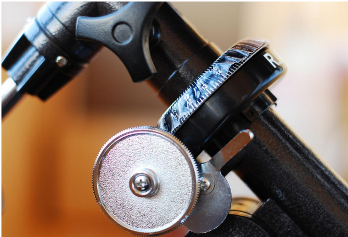
На монтажке предусмотрено крепление для установки часового привода на ось прямого восхождения. Привод в поставку не входит, его можно докупить отдельно.
