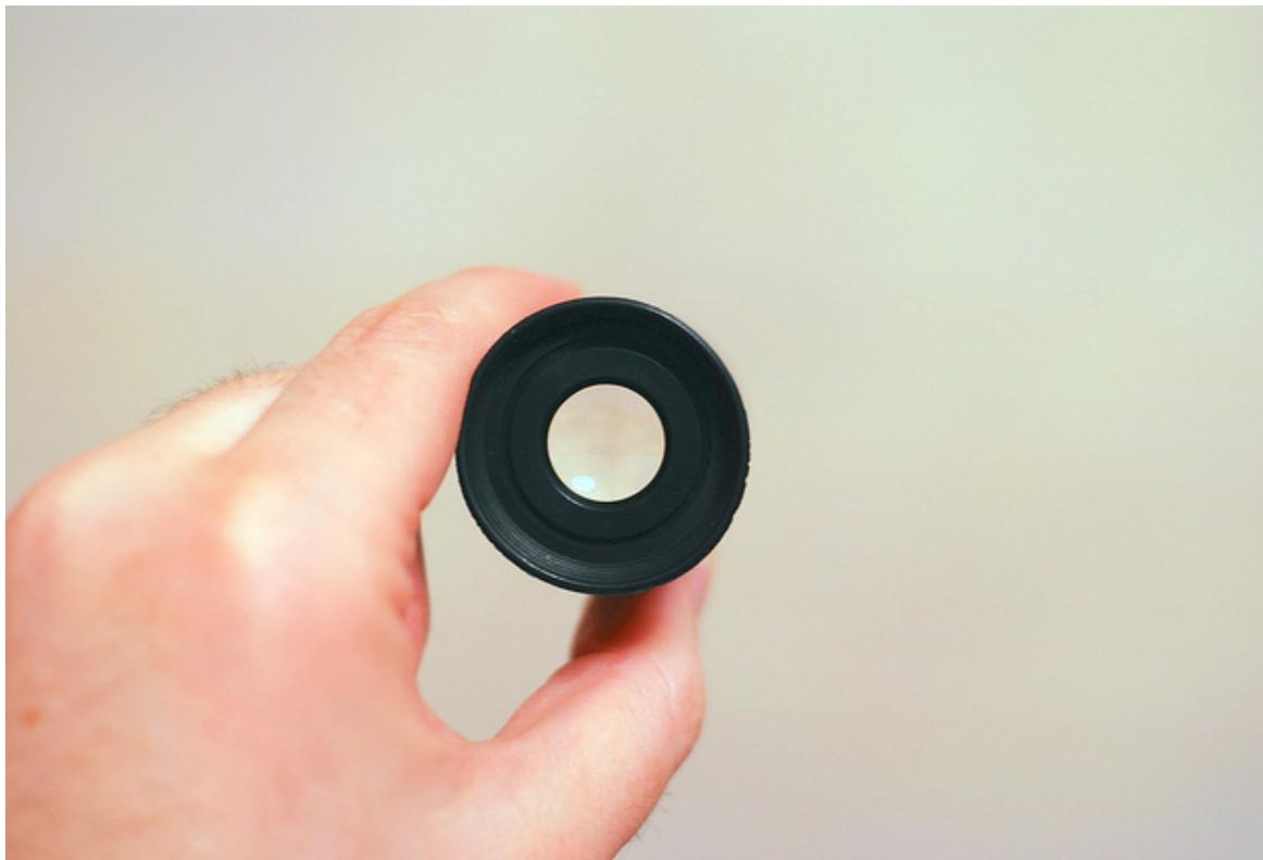
Следующий окуляр SUPER 10 мм. Просветленная оптика, чуть поменьше в размерах. Совместное использование с данным телескопом дает увеличение в 130 крат.
