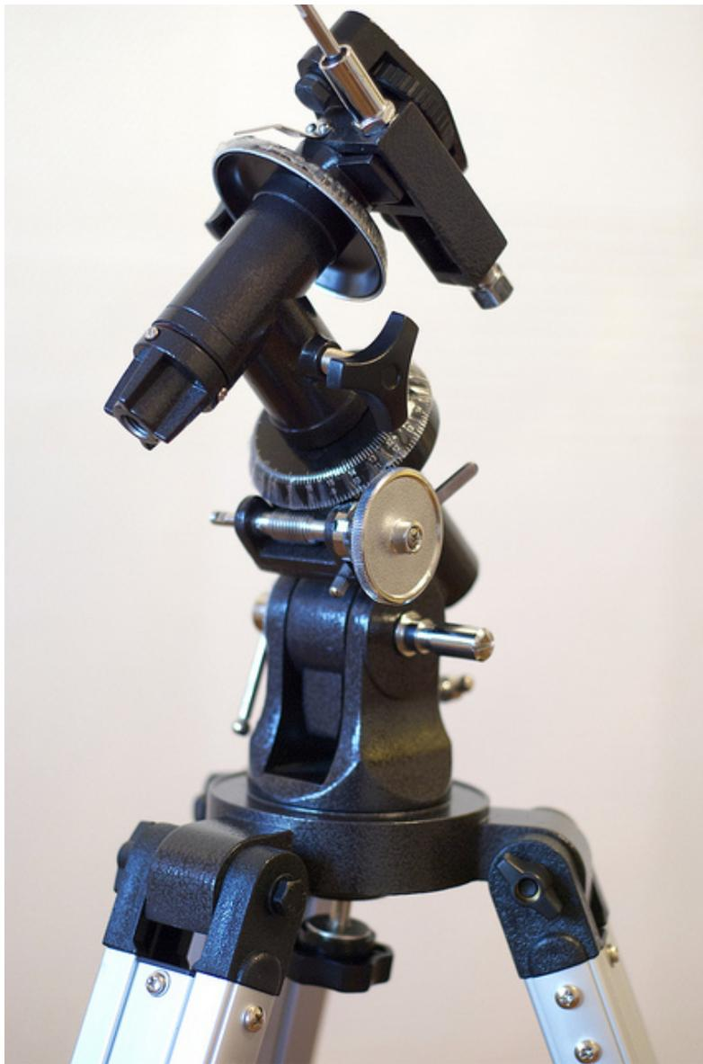
Монтировка снабжена двумя размеченными координатными кругами, которые облегчают поиск объектов на небе по координатам из атласа или планетария. Круги установлены на ось прямого восхождения и на ось склонений.
